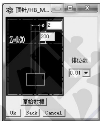
图 3-6-11 设置推杆参数
