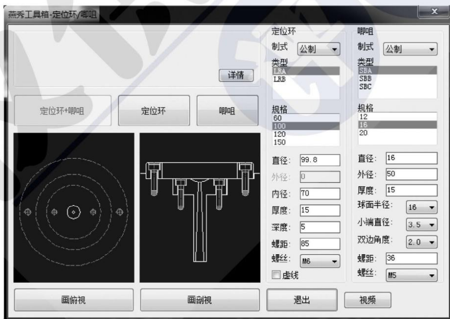
图 3-3-33 俯视图中浇口套与定位环参数设置
