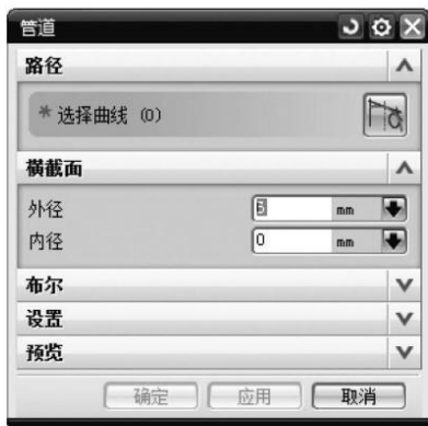
图 3-6-3 使用管道命令创建浇注系统
