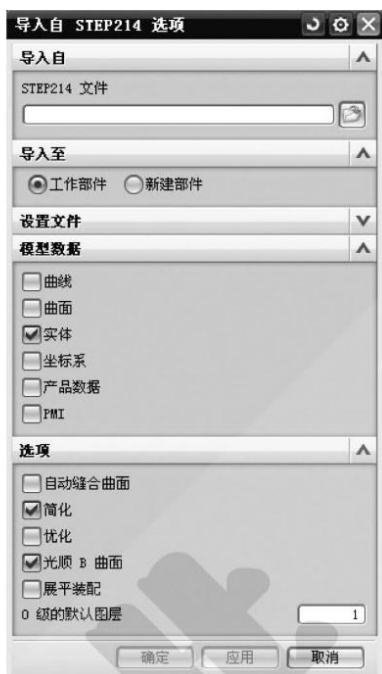
图 3-4-1 【导入自 STEP214 选项】对话框
